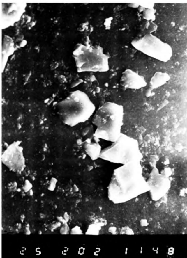
Ryc. 7. Izdebnó Kościelne, woj. mazowieckie. 2000-krotne powiększenie fragmentu przekroju pierścienia (por. ryc. 6) z widoczną fakturą powierzchni wnętrza pęcherzyka
