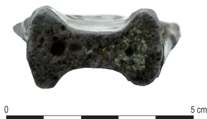
Ryc. 5. Siekierka z Grabszczyzny, pow. wołomiński: pęcherzyki powietrza na przełomie siekierki. Fot.: Ł. Karczmarek
