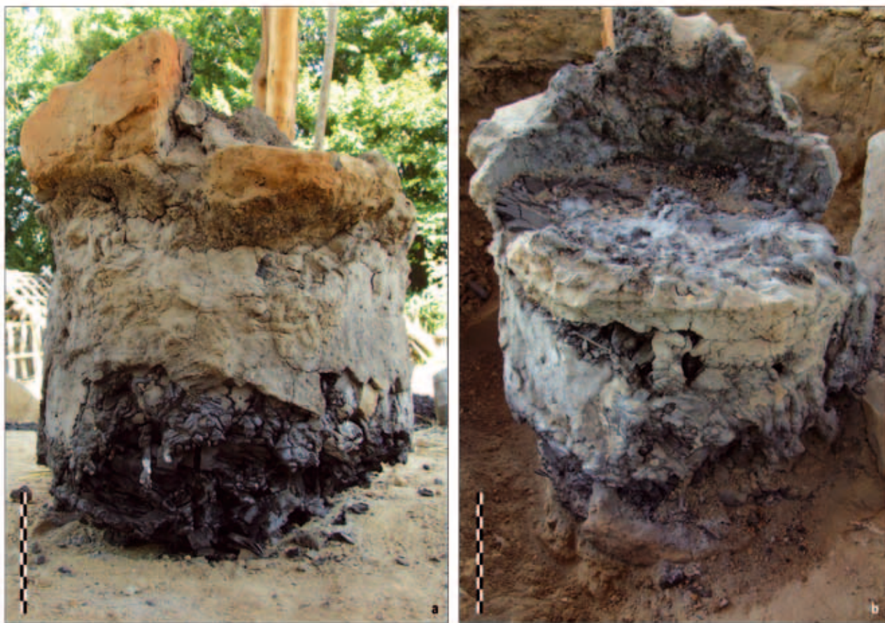
Ryc. 25. Kloc żuźlowy uzyskany w trakcie eksperymentalnego „wytopu” podczas „Dymarek Świętokrzyskich” w 2015 roku. Fot.: A. Wrona Fig. 25. Block of slag from experimental smelting during the “Holy Cross Bloomeries”, 2015. Photo: A. Wrona
