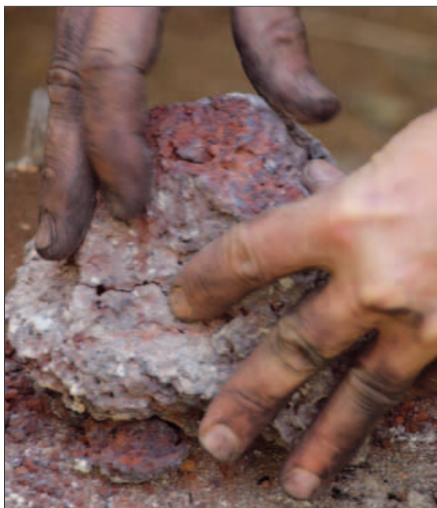
Ryc. 7. Przeprażona lokalna ruda pozyskana z hałd byłego Zakładu Wielkopiecowego w Starachowicach, użyta do eksperymentu w czasie seminarium w 2013 roku. Fot.: M. Rakalska Fig. 7. Roasted local iron ore obtained from the spoil heaps of the former Blast Furnace Plant (Zakład Wielkopiecowy) in Starachowice, used in experiments made within the Bloomery Seminar, 2013. Photo: M. Rakalska
