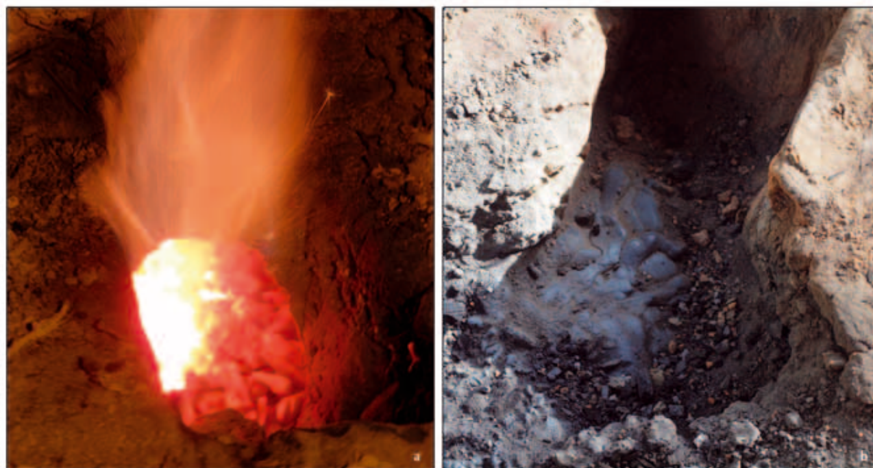
Ryc. 10. Seminarium w Starachowicach w 2013 roku: a – obserwacja przez otwarty kanał kotlinkowy stopnia upłynnienia żużla i wypalenia węgla drzewnego wypełniającego kotlinkę pieca; b – zastygły żużel częściowo wypełniający kanał kotlinkowy pieca po rozbiórce jego części szybowej. Fot.: M. Banasiewicz (a), M. Rakalska (b)
